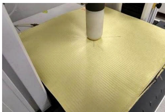
FIGURA 6 - POSICIONAMENTO DO PAINEL BALÍSTICO SOBRE A PLATAFORMA DO TESTE DE FLEXIBILIDADE.
